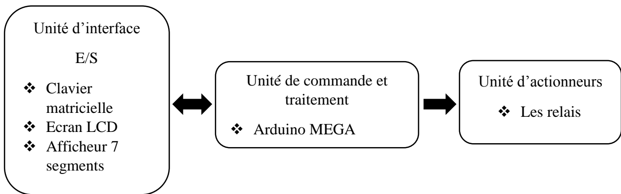
Figure 2. 1 : Schéma bloc de notre système de borne de chargement
