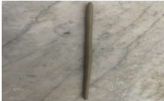
Fig.23 : Préparation du rouleau pour la détermination de W_p
