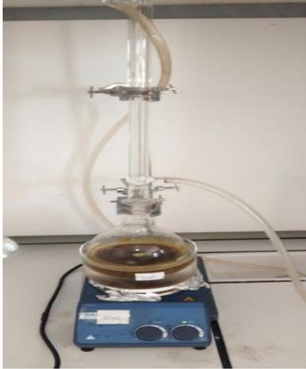
**Figure III.11.** Montage de mercerisation
