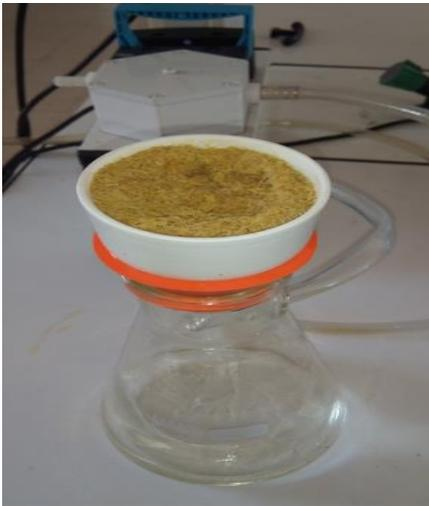
**Figure III.13.** Montage de filtration
