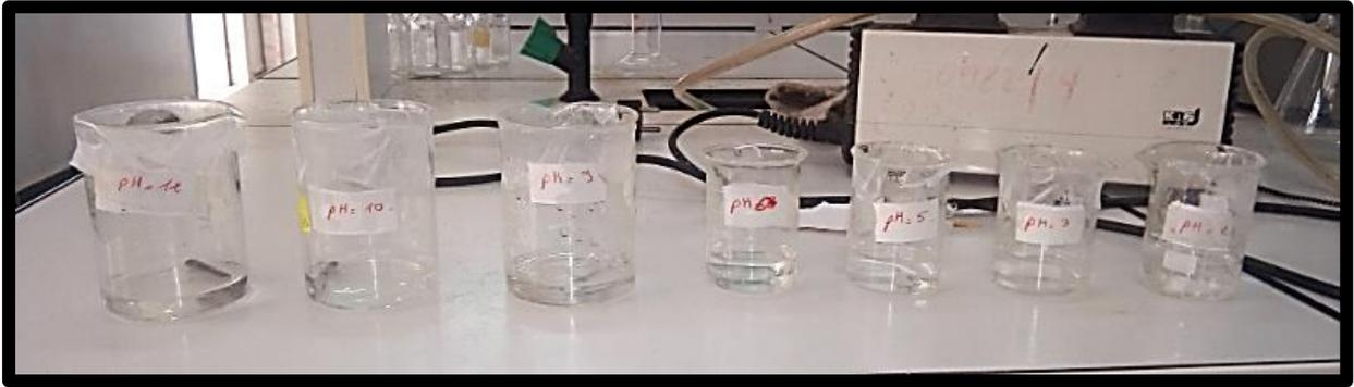
**Figure III.19.**Préparation les solutions pour déterminer le point isoélectrique
