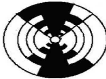
**FIGURE 1.12 ANTENNE LOG-PERIODIQUES CIRCULAIRE [9].**
