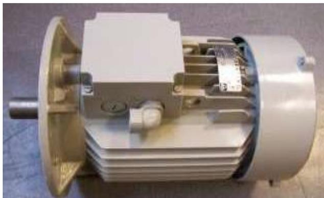
**Figure 1-15** Moteur asynchrone double étoile.
