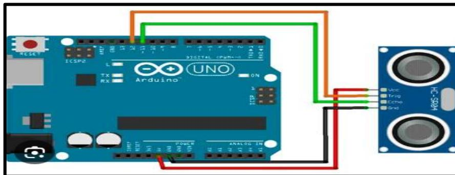
Figure II-4 : Schéma de câblage de HC-SR04
