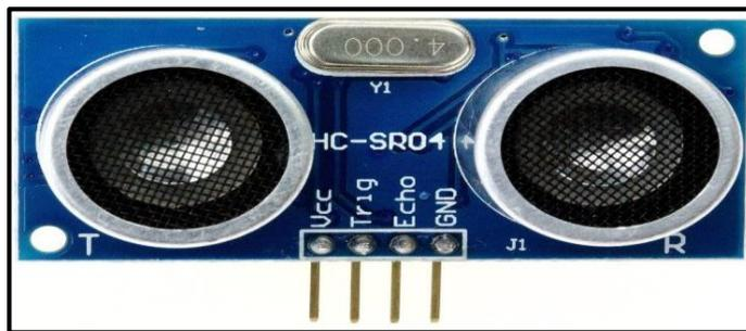
Figure II-2 : Module de capteur à ultrasons HC-SR04 [8]
