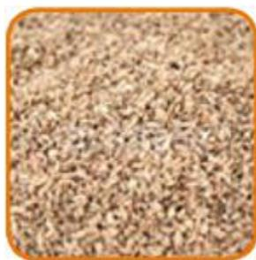
*Figure I. 34* Les granulats de liège sont utilisés en remplissage de caissons ou mélangés à du béton afin d'obtenir une chape légère et isolante.
