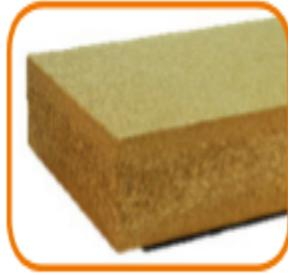
*Figure I. 38 Les panneaux de paille compressée sont obtenus grâce à un procédé de compression de la paille à chaud. Un revêtement en carton est ensuite collé sur les deux faces*
