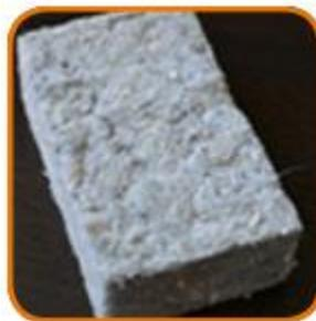
Figure I. 40 La ouate de cellulose peut être conditionnée sous forme de panneaux
