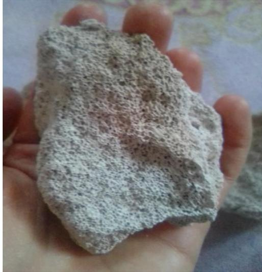
*Figure I. 26 Béton cellulaire utilisé dans la construction du mur*
