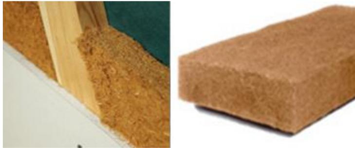
*Figure I. 30 La laine de bois et les panneaux en fibre de bois sont fabriqués grâce au défibrage du bois.*
