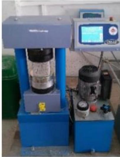
*Figure III. 9 Presse hydraulique (NA EN 12390-3)*
