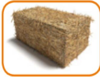
*Figure I. 36* Après fauchage, la paille est en général conditionnée sous forme de bottes. Celles-ci peuvent être utilisées telles quelles comme isolant dans une ossature bois.
