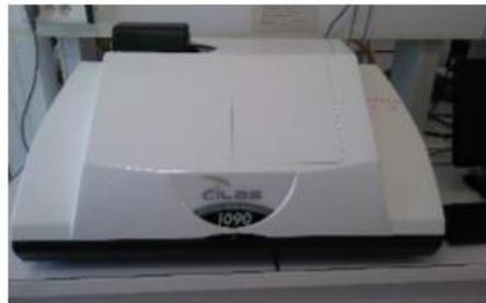
*Figure III. 12 Granulométrie laser (cillas 1090)*
