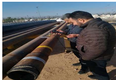
Figure.37 : Mesure d'épaisseur de tube par ultrason.
