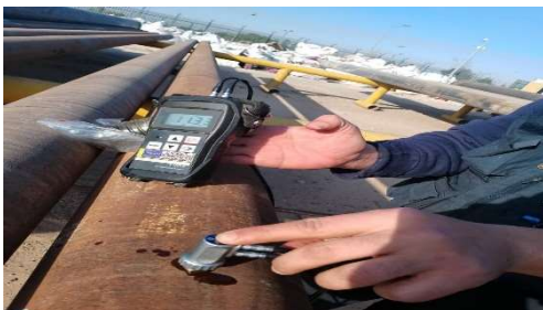
Figure.37 : Mesure d'épaisseur de tube par ultrason.
