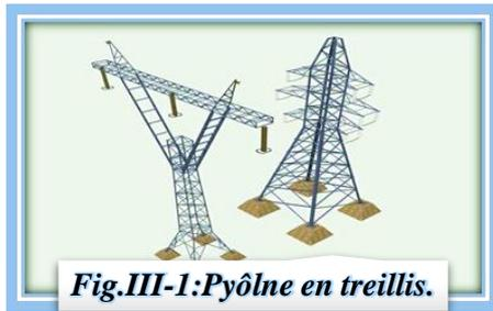
**Fig.III-1: Pylône en treillis.**
