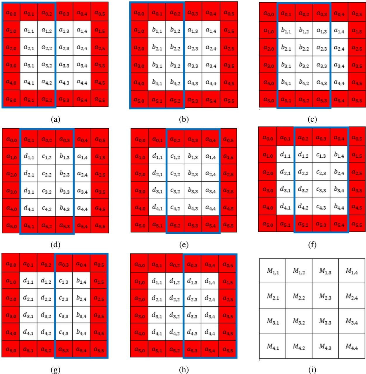
FIGURE 3.7 – Exemple du processus de diffusion proposé pour une matrice de taille  $4 \times 4$ . (a) Matrice encadrée par un ruban. (b) Matrice après l'application de la première opération. (c) Décalage de la zone de calcul d'une seule colonne. (d) Matrice après la seconde opération. (e) Décalage de la zone de calcul d'une seule colonne. (f) Après avoir appliqué les opérations sur la zone encadrée. (g) Un autre décalage. (h) Matrice après avoir été entièrement balayée. (i) Masque.
