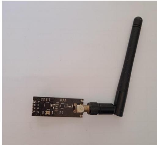
*Figure II.5 : le module nRF24L0+PA*
