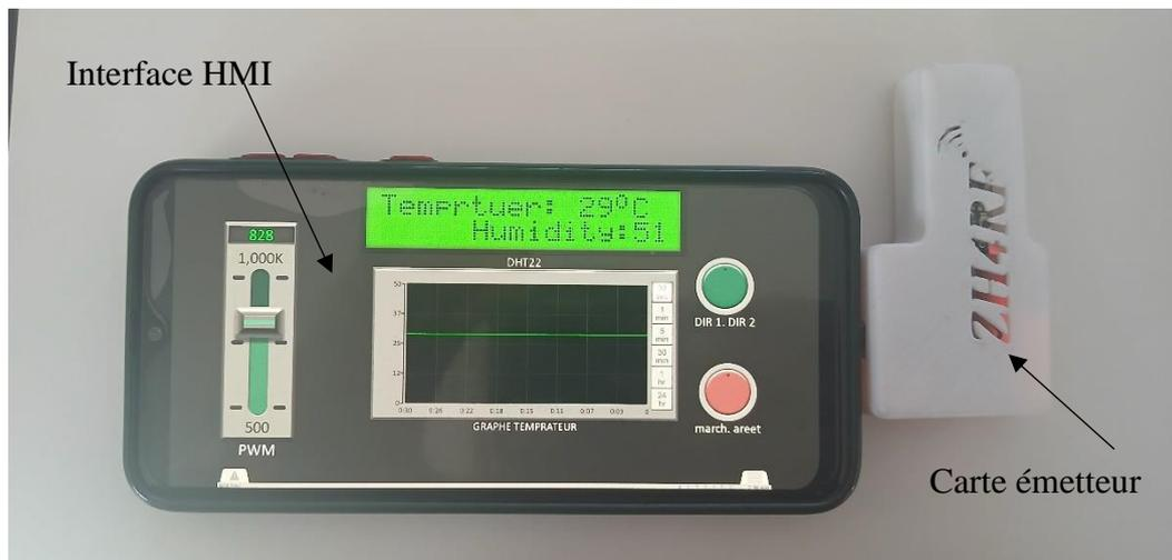
Figure III.8 : HMI interface avec la carte finale de premier prototype
