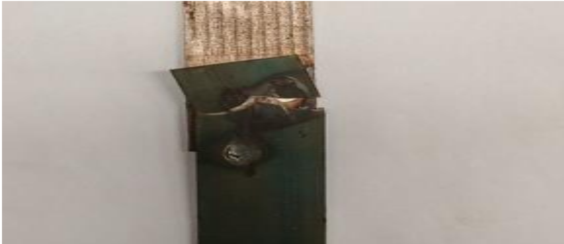
Figure IV-5 : Eprouvette après l'essai de traction avec P=500 daN et l'intensité =50 A.
