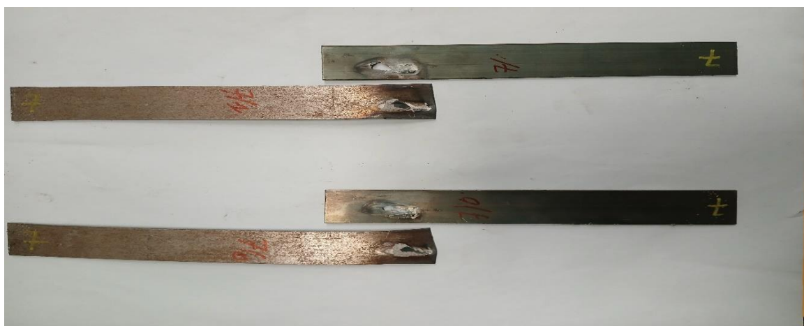
Figure IV-1 : Eprouvettes après le soudage
