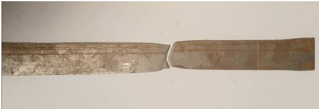
Figure III-15 : Eprouvette d'Acier E 24 après l'essai de traction
