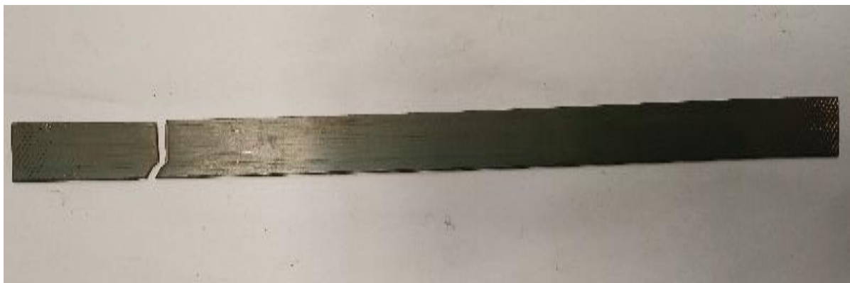
Figure III-17 : Eprouvette d'Acier XC 75 après l'essai de traction
