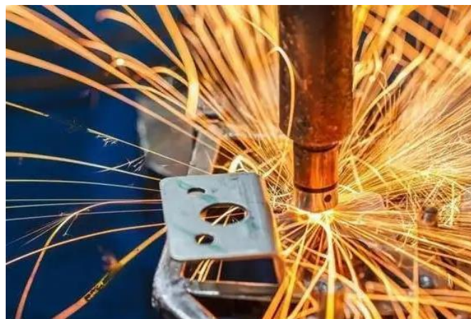
Figure II-6 : Arcs chauffants en soudage par points [1]
