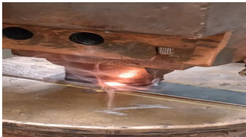
Figure III-08 : Soudage des éprouvettes
