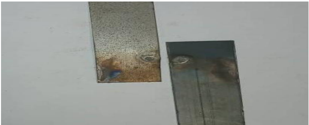
Figure IV-4 : Eprouvette après l'essai de traction avec P=400 daN et l'intensité = 40 A.
