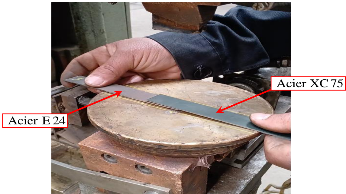
Figure III-07 : Placement des éprouvettes
