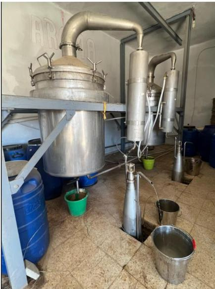
**Figure 4- Alambic en acier inoxydable (Photographée Originale)**
