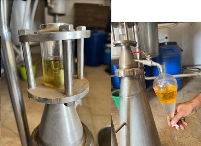
**Figure 5- Essencier pour séparer les deux phases (Photographées Originale)**
