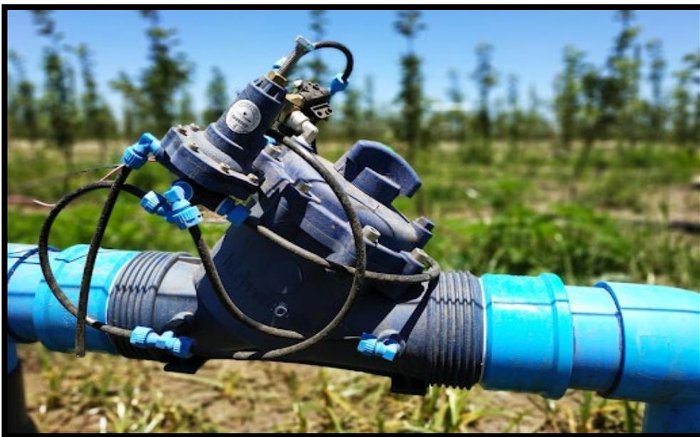
**Figure 14.** Vanne d'irrigation automatisée.
