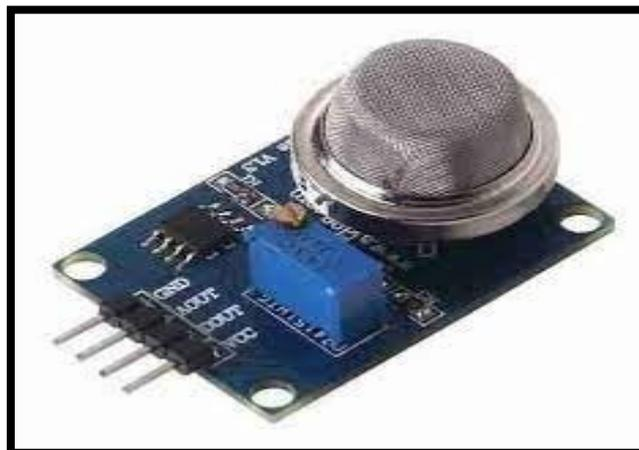
**Figure 10 :** détecter des gaz, polluants et fumées
