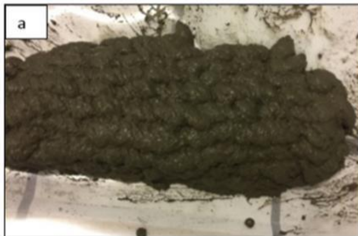
Figure 32 : Effondrement d'un mortier constructible (environ 8 couches) en raison d'une instabilité de structure.
