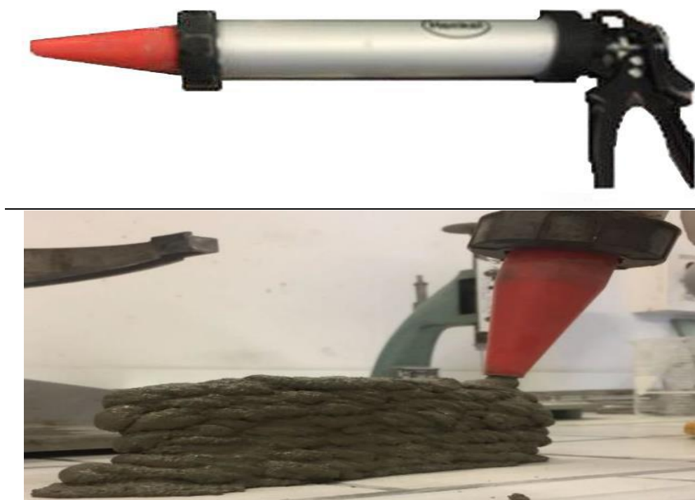
Figure 26 : Pistolet utilisé pour l'impression 3D manuelle.
