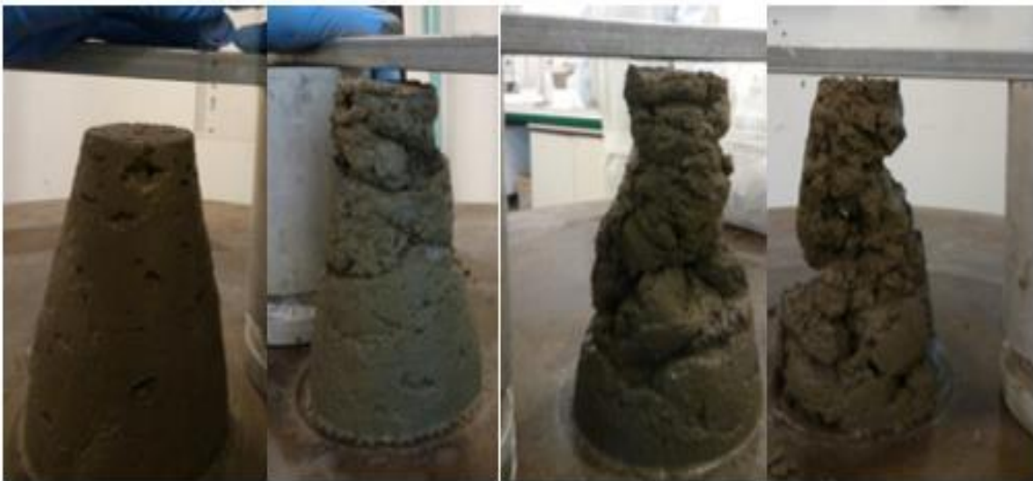
Figure 42 : Cône MBE test réalisé sur le mortier 93/7 en laissant le mortier au repos à 20, 30, 45 et 60 minutes respectivement.
