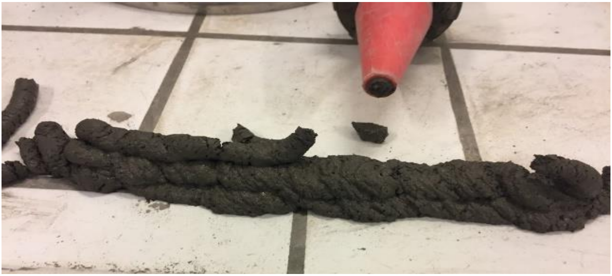
Figure 29 : Blocage de la buse à cause du durcissement ou la filtration du mortier.
