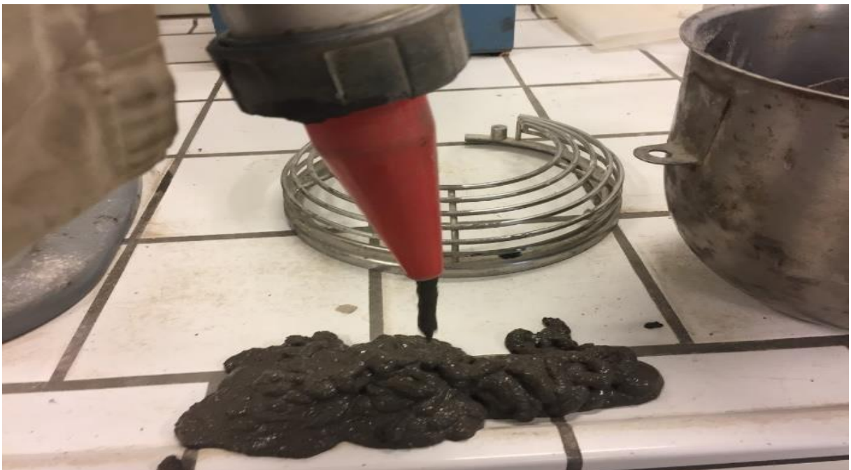
Figure 30 : Exemple d'un matériau trop fluide.
