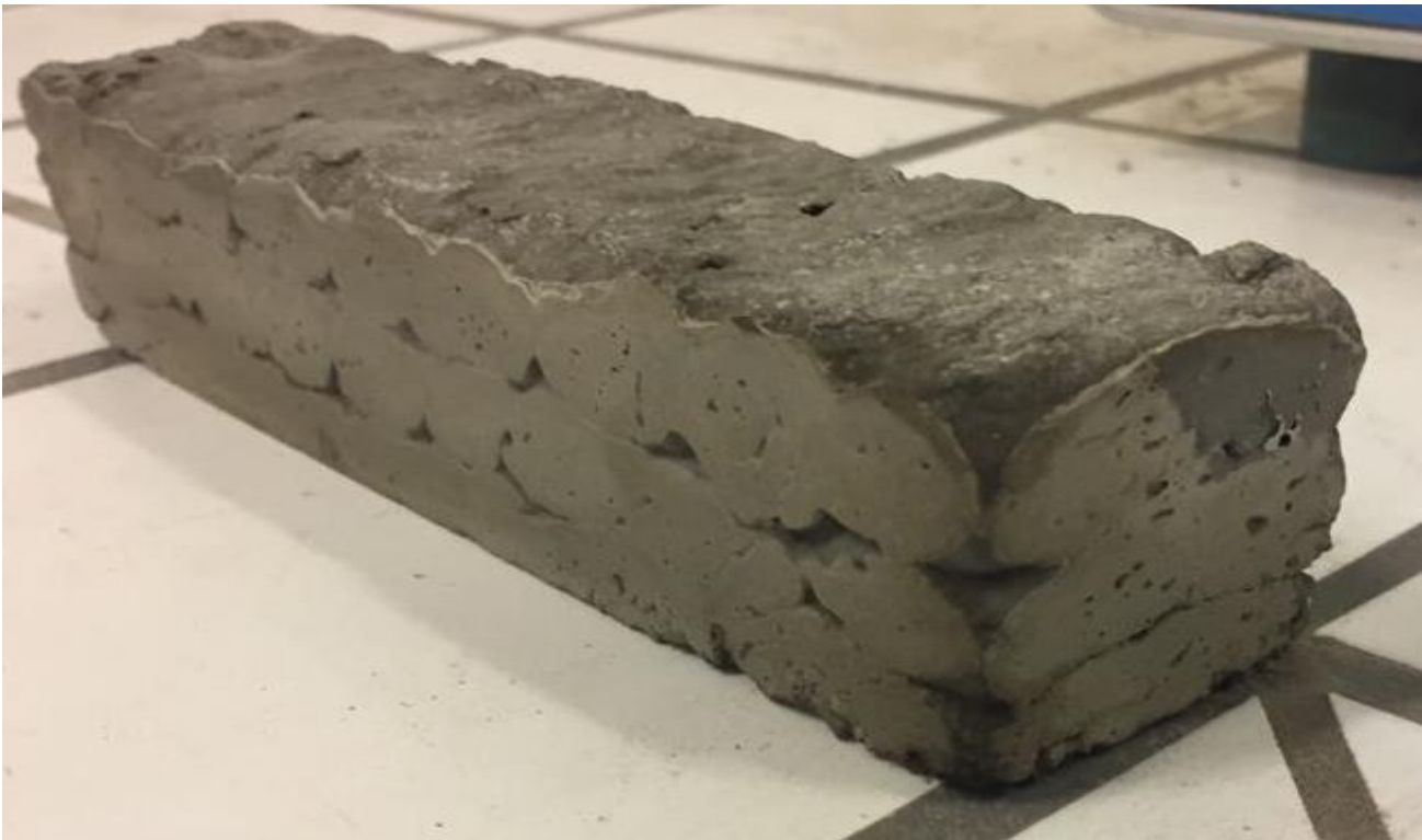
Figure 41 : Développement de spécimens 4x4x16cm imprimés pour les essais mécaniques.
