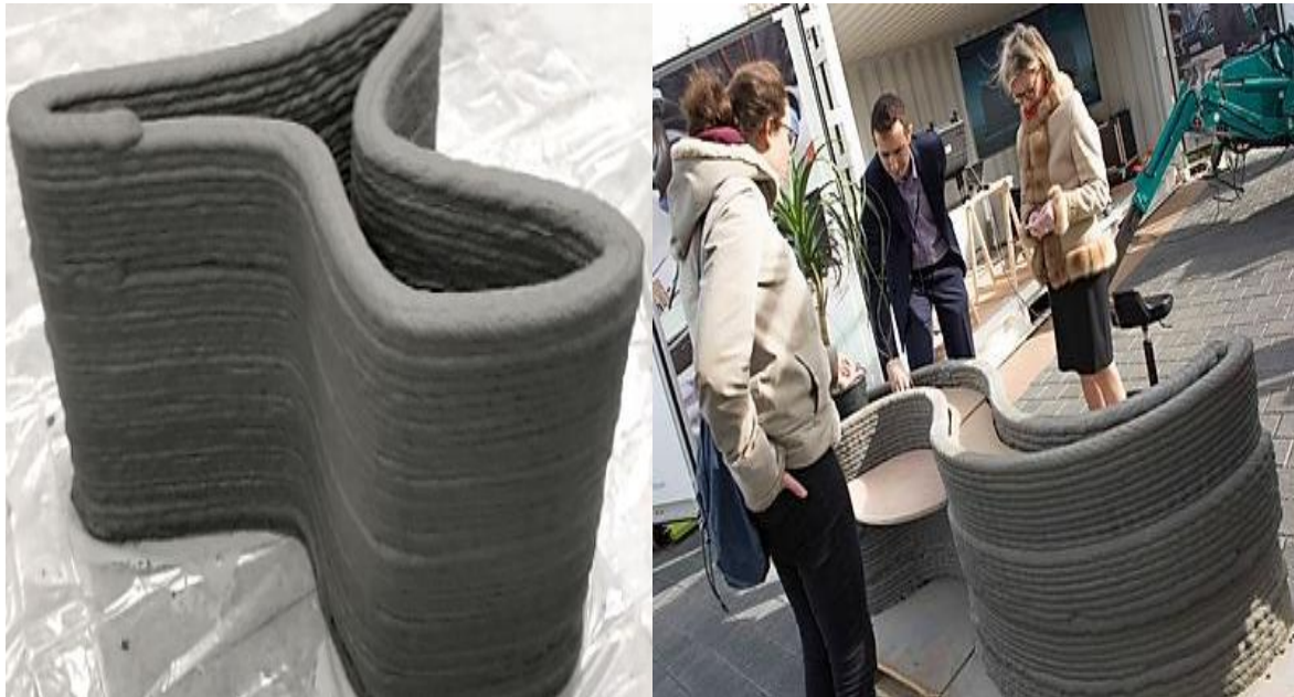
Figure 7 : Mobilier urbain imprimé par l'entreprise "Construction 3D".
