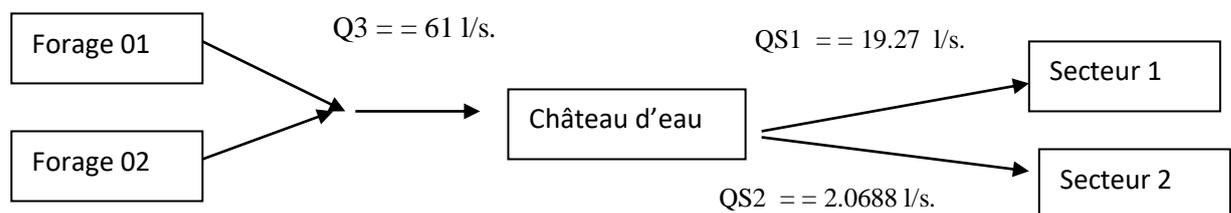
Figure 3.5. Dispositif de fonctionnement de l'amené
