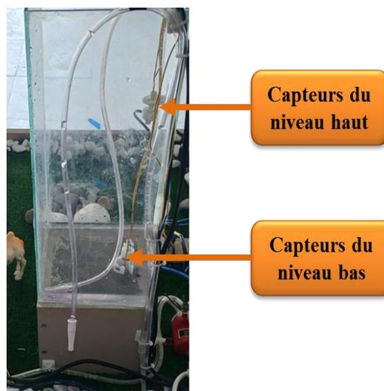
Figure 3-12 Capteurs du niveau bas et haut de réservoir.
