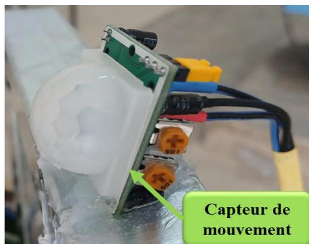
Figure 3-10 Méthode de câblage de capteur de mouvement.
