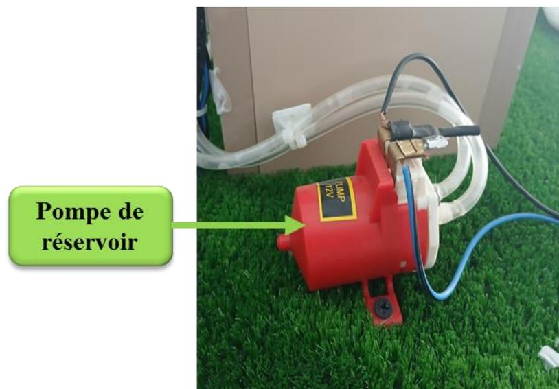
Figure 3-15 Pompe de réservoir.
