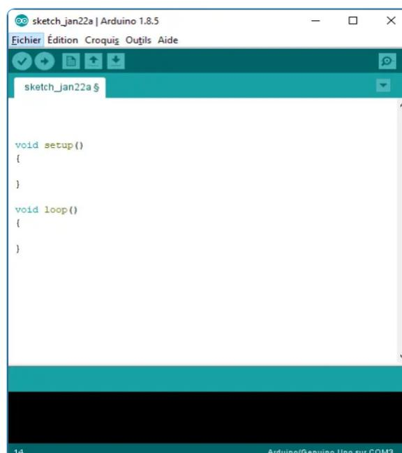
Figure 3-22 Structure d'un programme Arduino.
