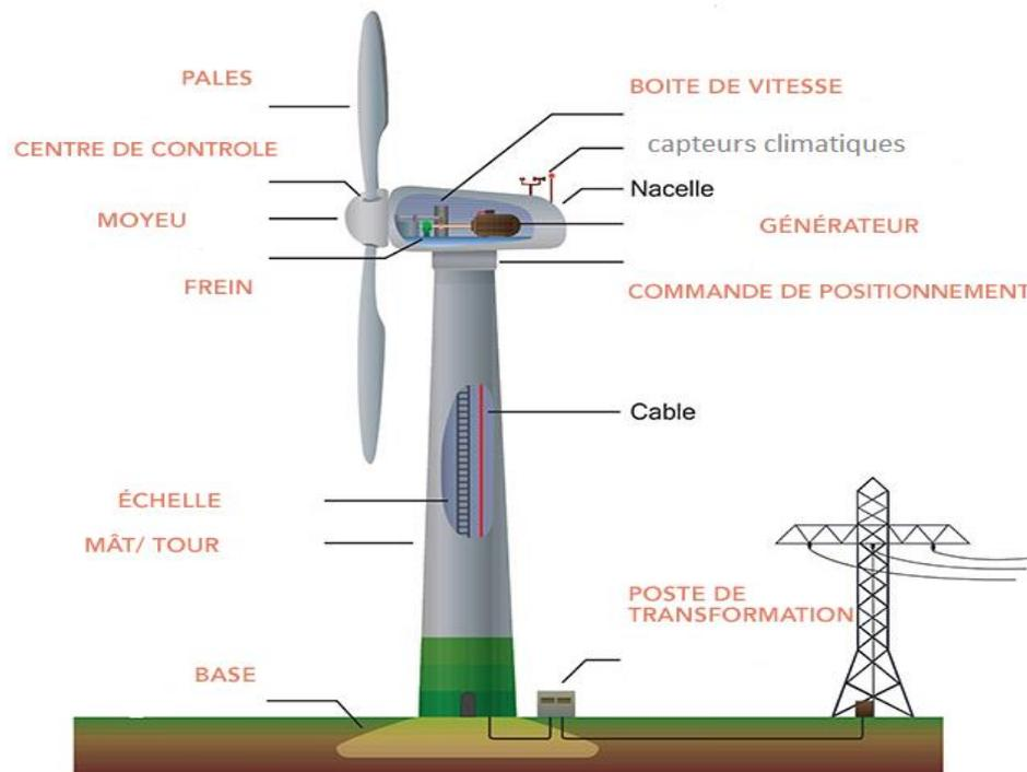
Figure 1-4 Différents composants d'une éolienne.
