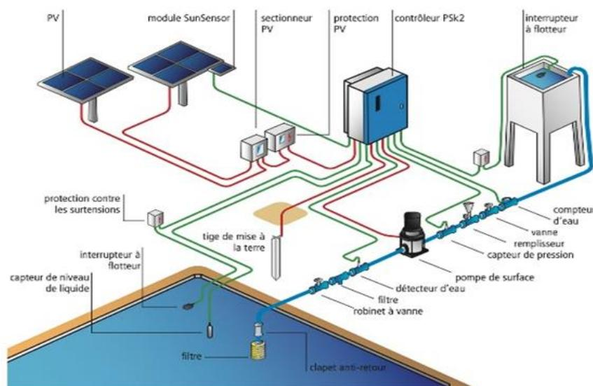
Figure 2-8 Conception d'une station d'irrigation intelligente avec panneaux solaires, capteurs et systèmes de contrôle à distance.
