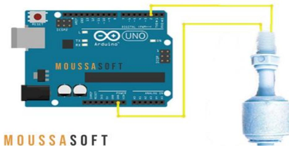
Figure 3-25 Montage de capteur de niveaux avec Arduino Uno.
