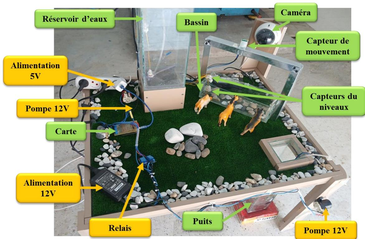
Figure 3-9 Photographie du banc expérimental.
