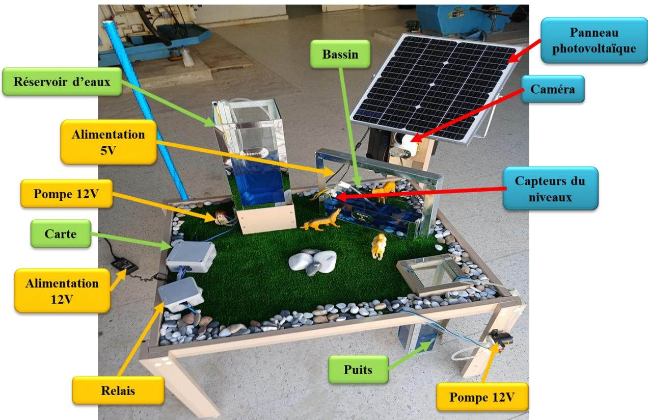
Figure 3-26 Simulation et expérimentale du système étude.
