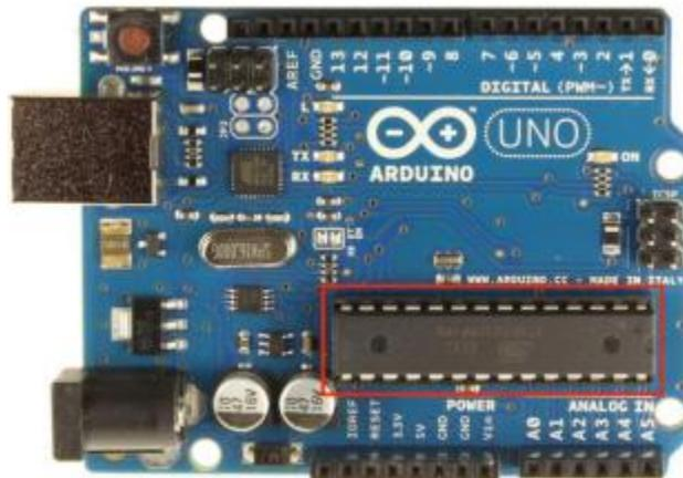
Figure 3-19 Microcontrôleur de la carte Arduino UNO.
