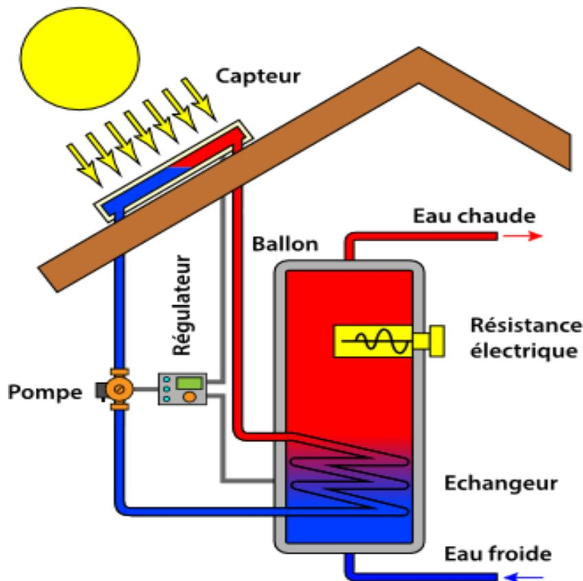
Figure 1-1 Principe de fonctionnement de l'énergie solaire thermique.
