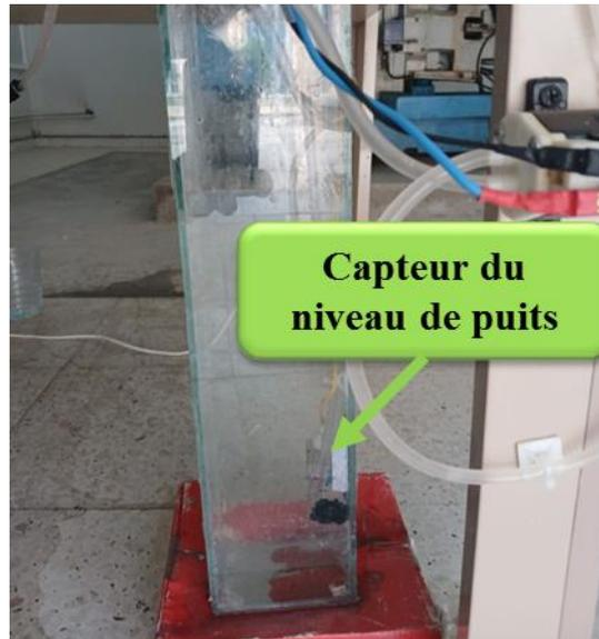
Figure 3-11 Capteurs du niveau de puits.
