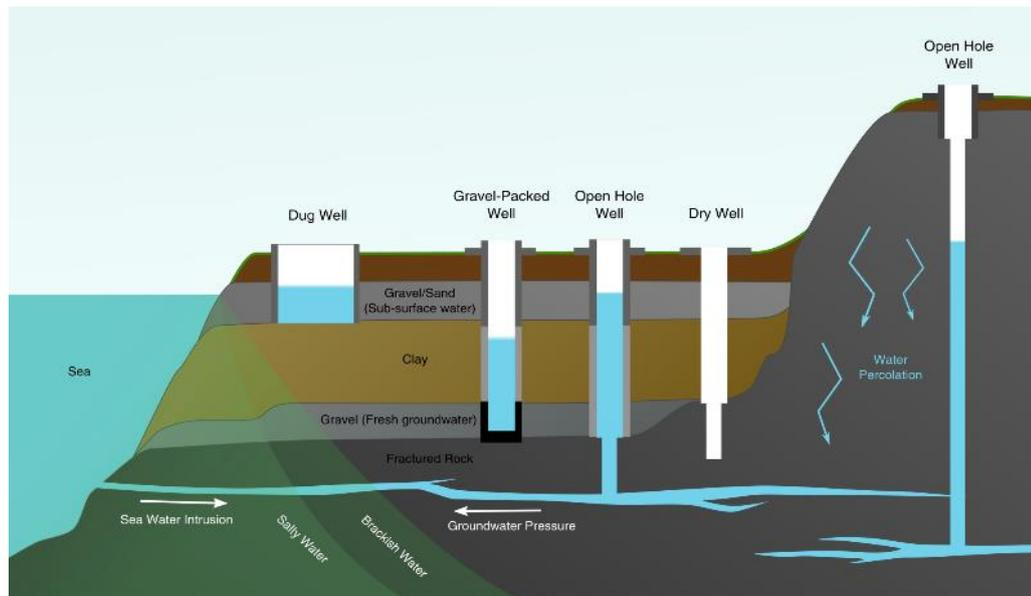
Figure 2-10 Eaux souterraines et les eaux de surface.
