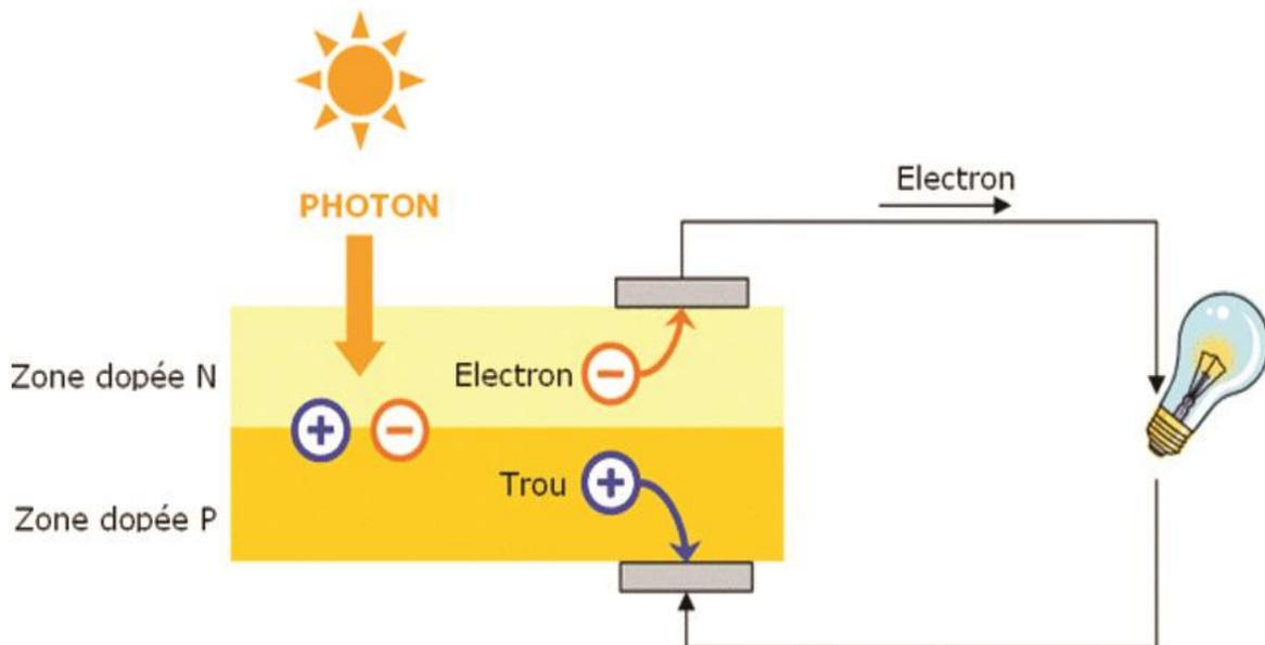
Figure 1-2 Principe de la conversion photovoltaïque.
