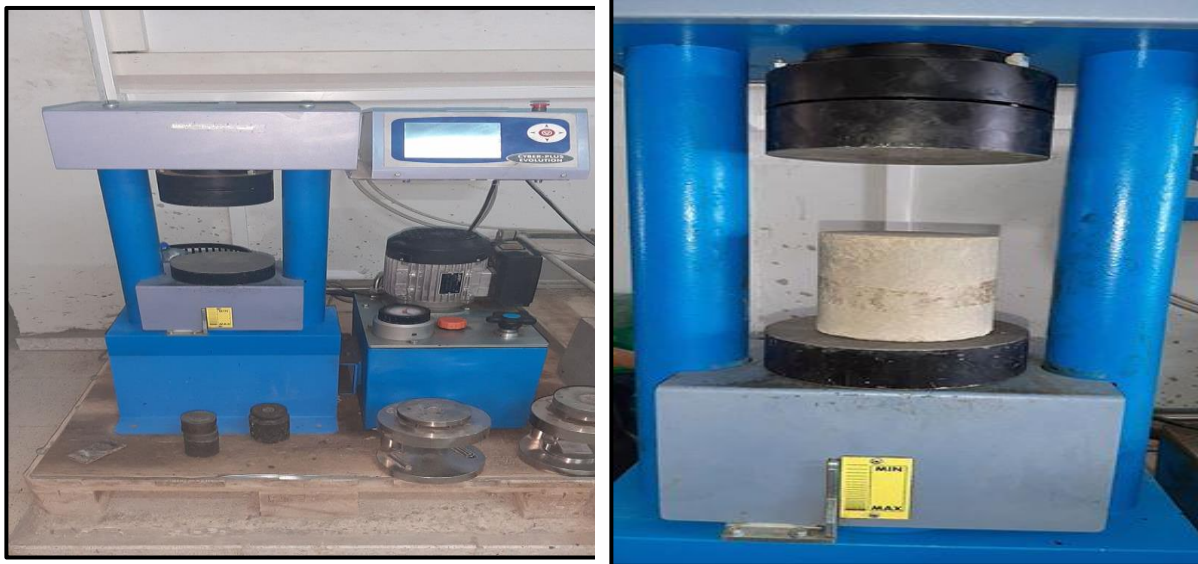
Figure II. 5: Vue d'ensemble de dispositif de mesure la résistance à la compression simple
