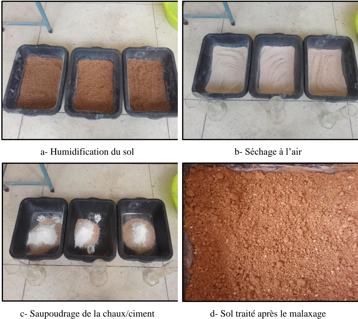
Figure II. 1: Préparation du sol traité
