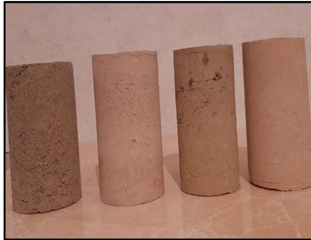
Figure II. 4: Types d'éprouvettes confectionnés pour la mesure de résistance à la compression simple
