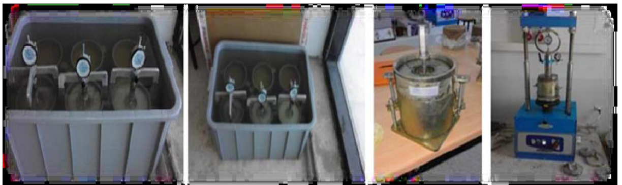
Figure III.15 : CBR du sol traité en liant hydraulique et déchets de cramique a l'Etat immergée (à la cure).
