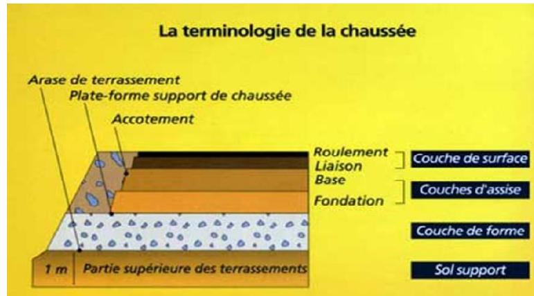
Figure II.7. La terminologie de la chaussée.[4]
