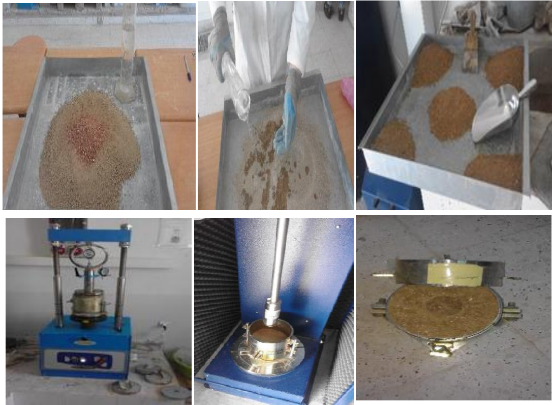
Figure III.16 : Déroulement de l'essai –CBR.
