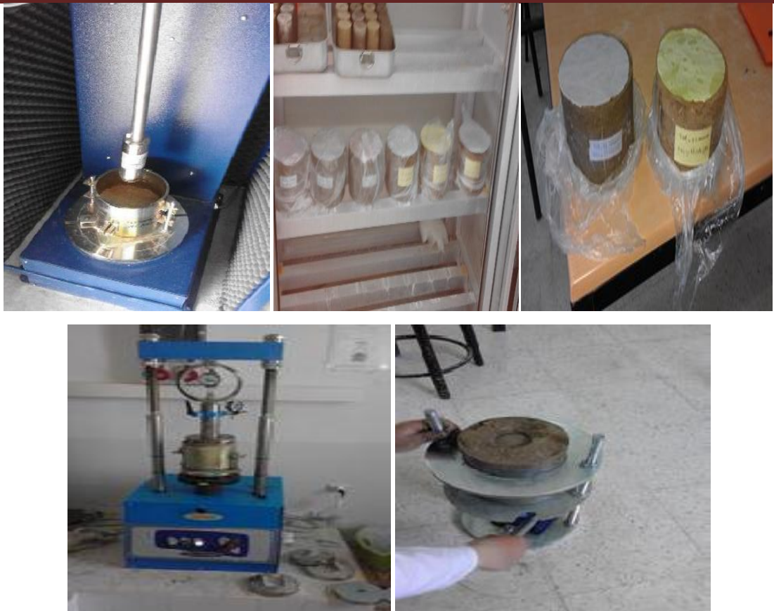
Figure III.14 : CBR du sol traité en déchets de cramique et liant hydraulique après plusieurs jours (7j ; 14j ; 28j).
