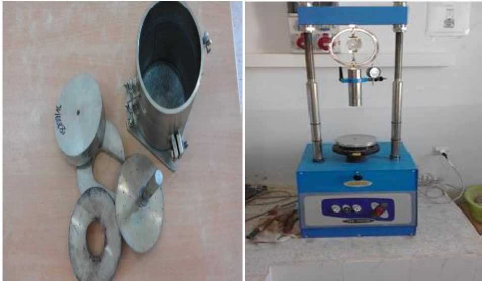
Figure III.12 : Appareillage pour l'essai CBR.
