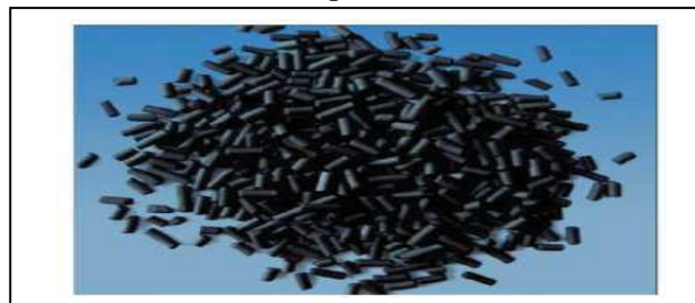
Figure III.6: Charbon actif en extrudé.
