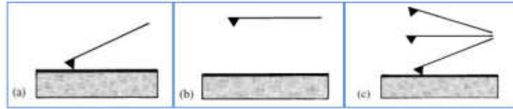
Figure II.9 : Illustration des modes de fonctionnement de l'AFM, a) Mode contact, b) Modes non contact, c) mode tapping.
