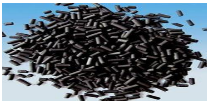
Figure II.7: Charbon actif en extrudé.
