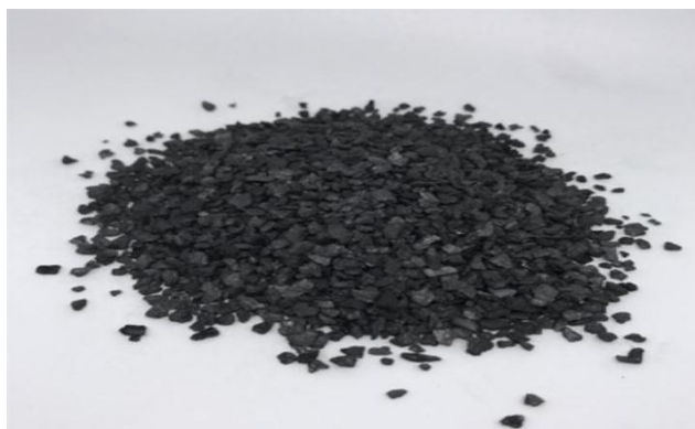
Figure II.6: Charbon actif en grain.
