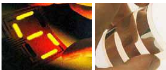
Figure III-10 : Dispositifs électroniques ou optoélectroniques à base de polymères conjugués : diodes électroluminescentes, cellules photovoltaïques et transistors à effet de champ (de gauche à droite).
