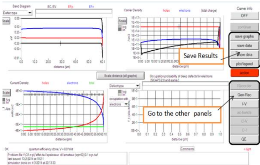
Figure III.4 : Panneau des bandes d'énergie. [03]
