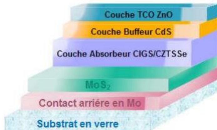
Figure IV.41 : Structure de la cellule solaire au CIGS ou CZTSSe.
