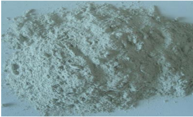
photo III.4 : laitier de haut fourneau
