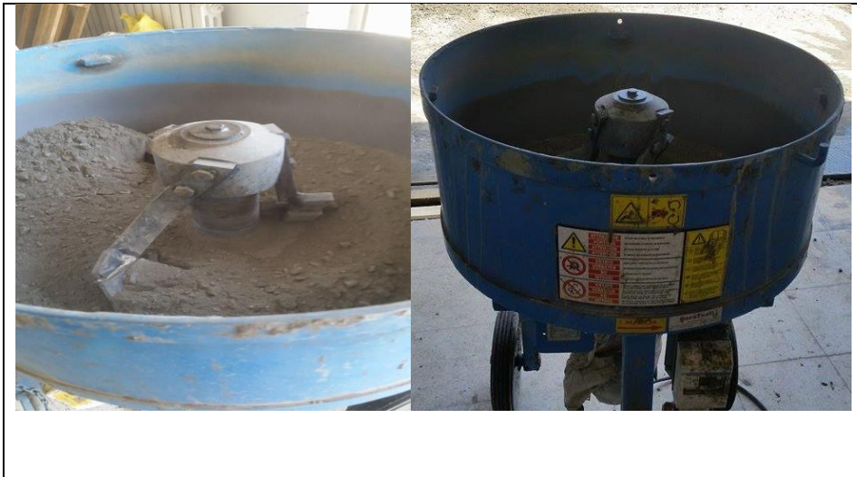
Photo III.10 : Malaxeur à béton laboratoire des (MDC).
