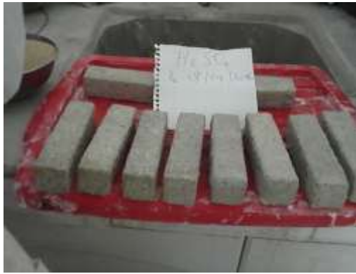
Photo (II-3) : des éprouvettes après 9 j d'immersion dans H 2 SO 4
