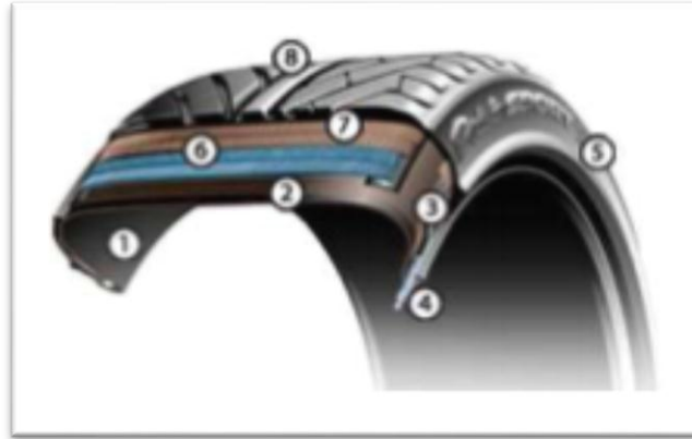
Figure 17 : Coupe transversale d'un pneu Michelin [42].
