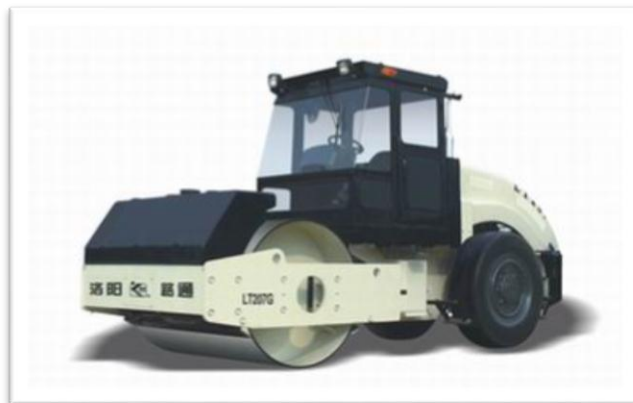
Figure 9 : Rouleau vibrant mono roue d'acier à pneus lisses [19]
