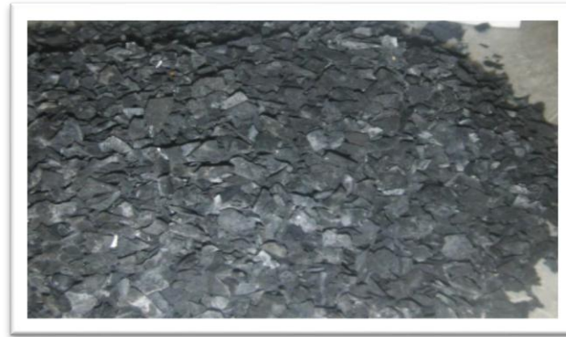
Figure 71: Caoutchouc traité par NaOH
