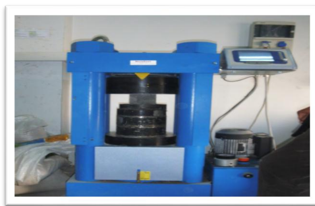
Figure 32: éprouvette cubique placée entre les plateaux d'une presse hydraulique
