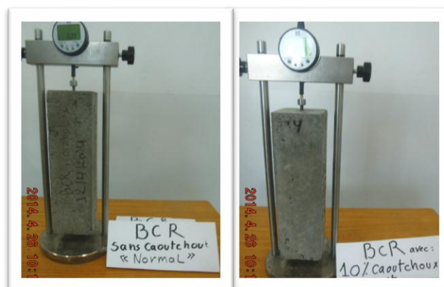
Figure 34: dispositif utilisé pour l'essai retrait
