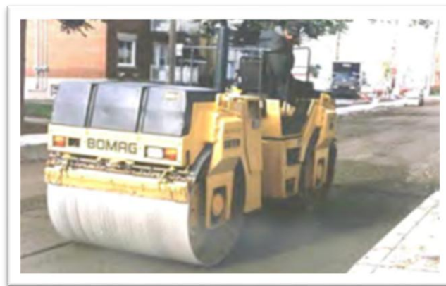
Figure 10: Rouleau compacteur tandem à cylindres métalliques lisses. [3]
