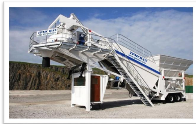
Figure 2 : Les centrales de béton mobile-[ 16]
