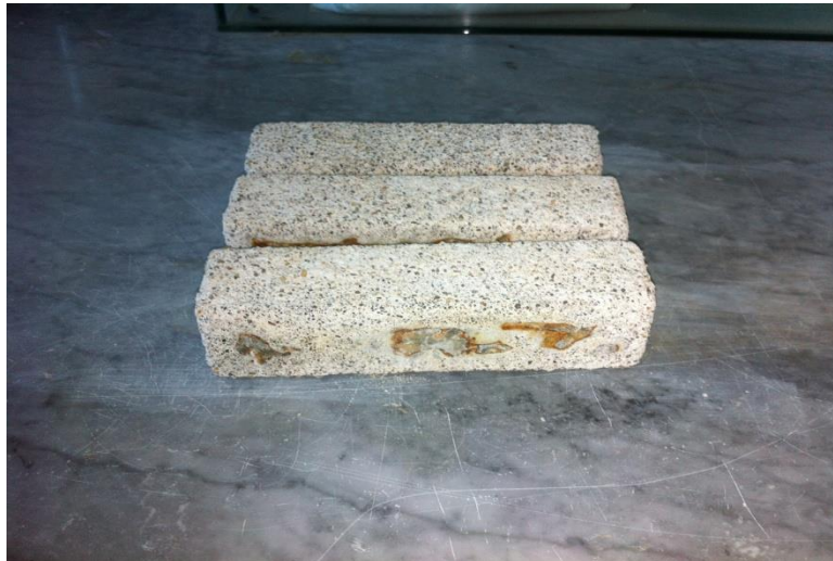
Photo (III.1) : Dégradation des éprouvettes immergées dans l'acide sulfurique ( H_2SO_4 ) 3,5%.
