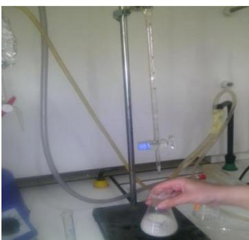
Figure: L'échantillon avant le titrage.
