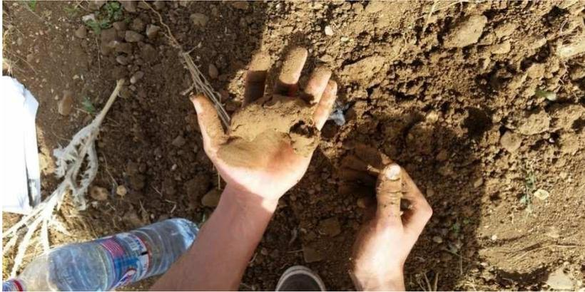
**Test d'élasticité :** Le principe du test est d'enrouler le sol mouillé entre les deux mains et formé avec in cylindre en suit un croisant. La figure ci-dessous nous montre la présence d'un taux assez élevé en argile.
