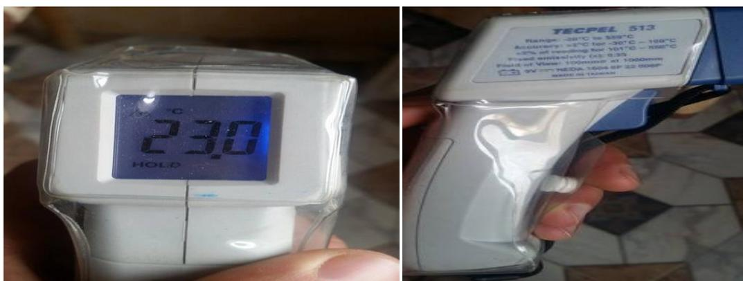
**Figure 09** : Le thermomètre infrarouge.
