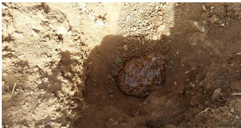
**Plasticité :** Le test est basé sur le principe de mélanger une petite quantité du sol entre les doigts de la main (pétrissage par l'eau), durant cette opération le sol a claqué (dégagé un son) donc le sol contient de l'argile.
