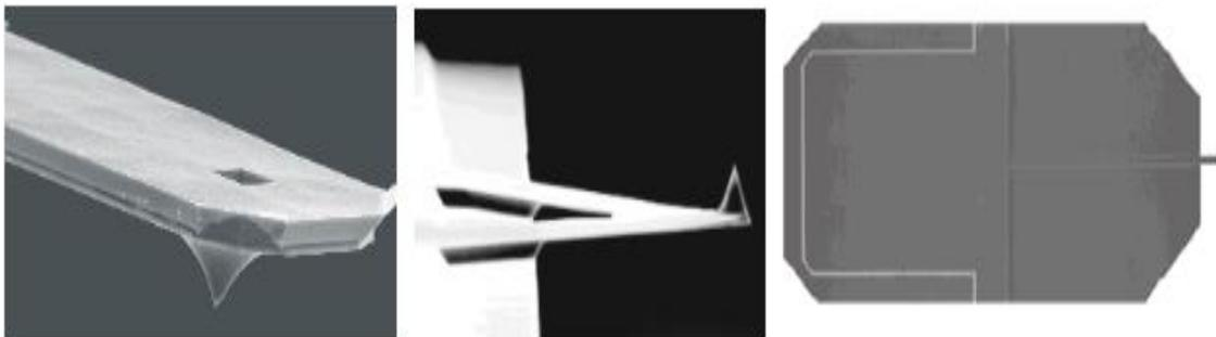
*Figure 1.16 : Exemple de leviers de pointe AFM et support de pointe.*
