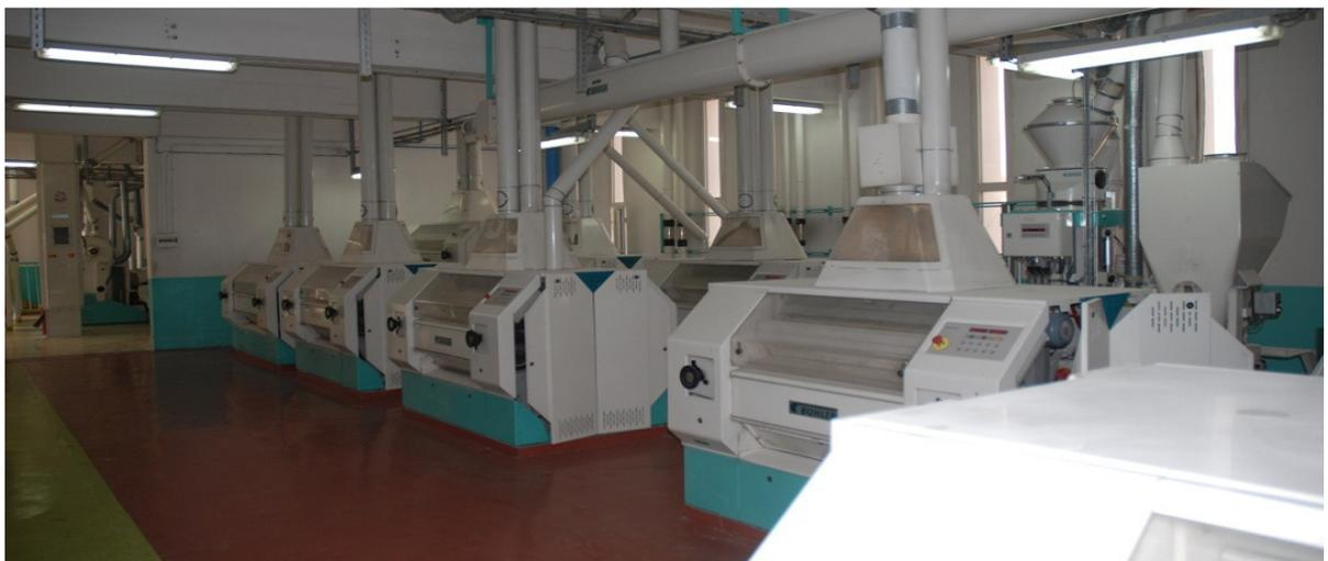
**Figure 8:** Broyeurs à cylindres de marque BUHLER.
