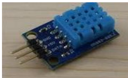
Figure 3.10 : Capteurs de température et d'humidité (DHT11).
