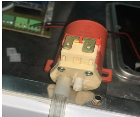
Figure 3.7:Pompe à eau.
