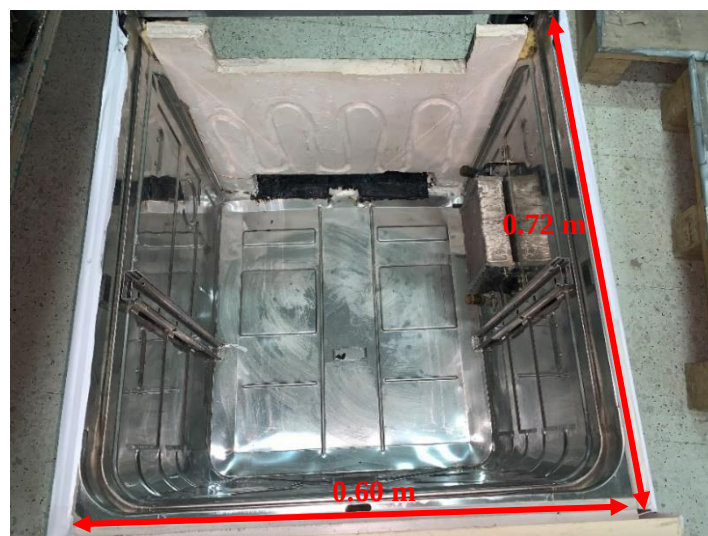
Figure 3.2 : Enveloppe intérieure du couveuse passive.
