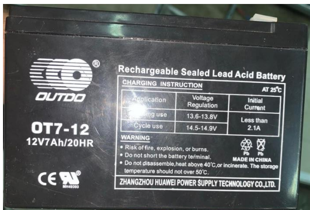
Figure 3.8:Batterie rechargeable et leur module de charge.
