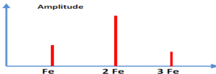
Figure I. 10: Signature spectrale d'un engrènement avec entraxe insuffisant [34].
