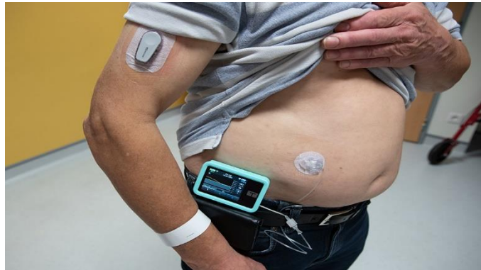
Figure 1.5 : Pompe à insuline et capteur de surveillance continue du glucose.
