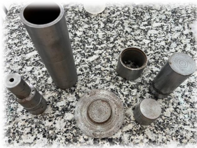
Figure III.9 : Moule métallique utilisé pour la fabrication des éprouvettes cylindriques.
