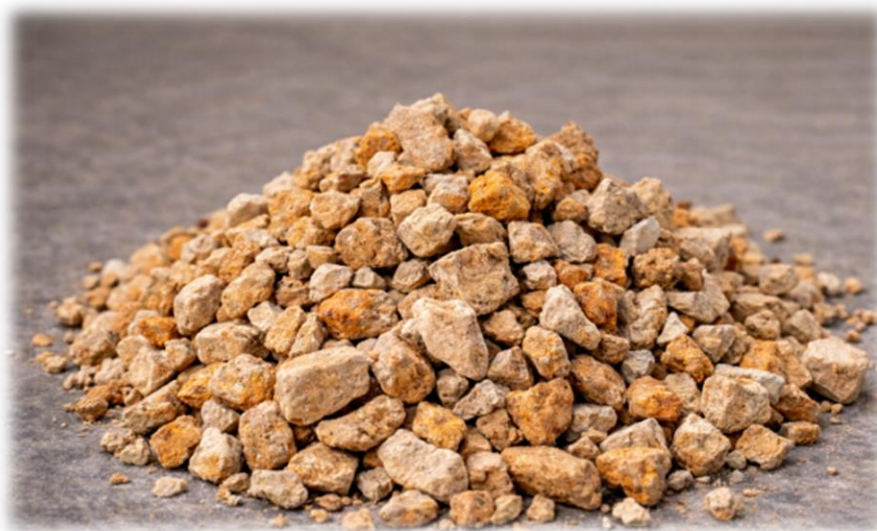
Figure II.6 : Chamotte obtenue après cuisson et broyage de l'argile
