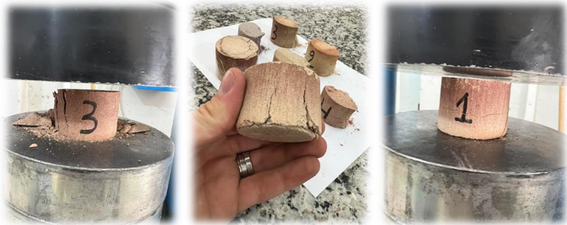
Figure III.16 : Essai de compression réalisé sur les éprouvettes réfractaires.
