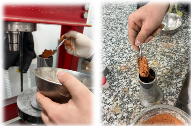
Figure III.10 : Remplissage du moule et préparation des éprouvettes avant compactage
