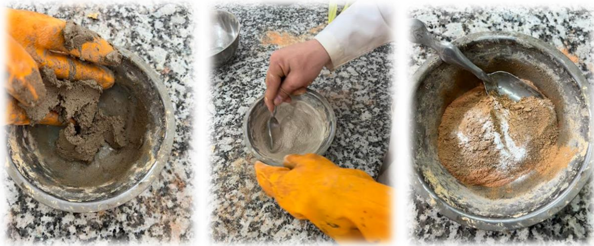
Figure III.8 : Préparation et homogénéisation des mélanges expérimentaux avant compactage.
