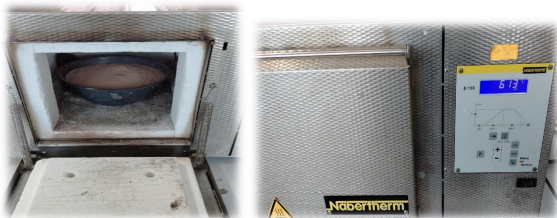
Figure III.2 : Four électrique utilisé pour la calcination du kaolin à 750°C.
