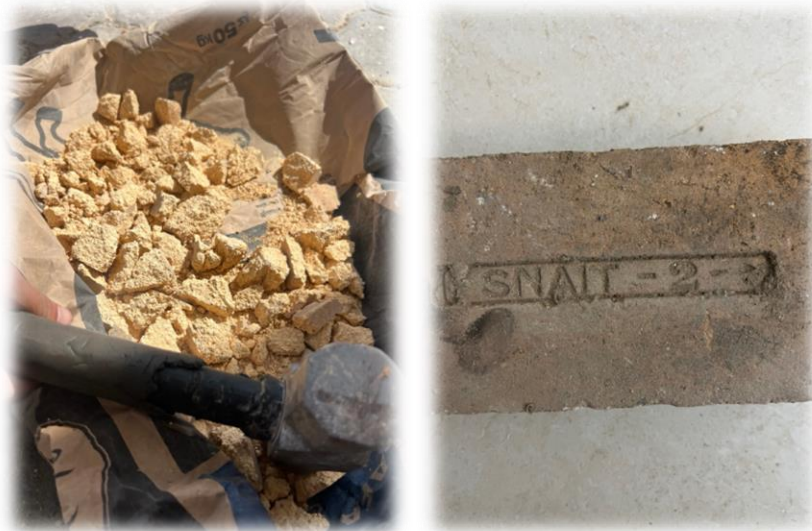
Figure III.3 : Préparation de la chamotte recyclée à partir de déchets de briques réfractaires.
