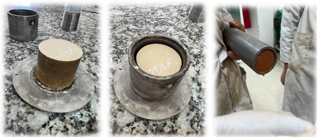
Figure III.15 : Mise en forme des éprouvettes cylindriques par compactage uniaxial et opération de démoulage.
