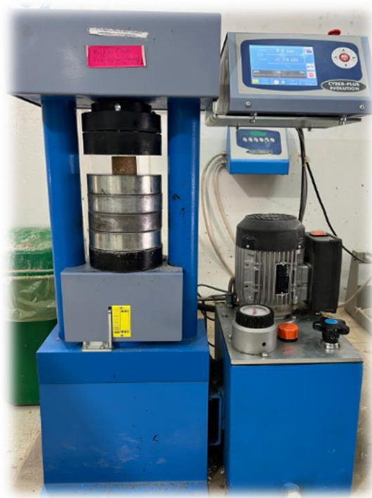
Figure IV.2 : Machine d'essai de compression utilisée pour la détermination de la résistance mécanique.
