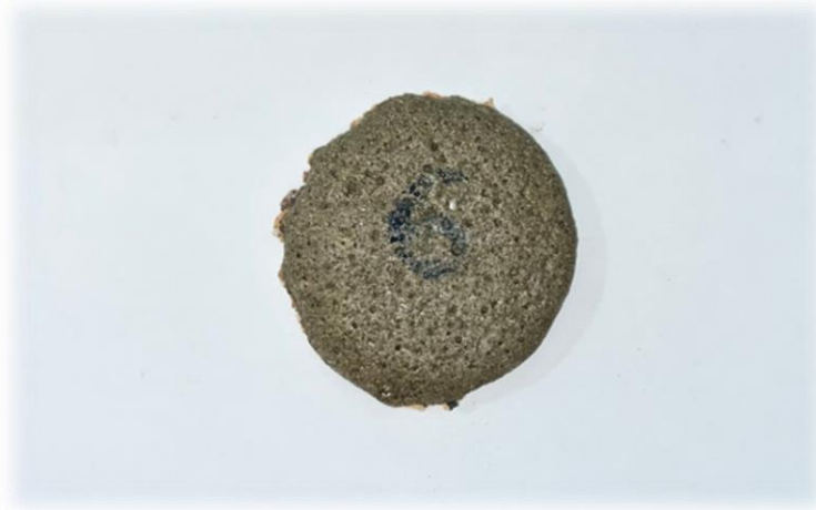
Figure IV.9 : Fusion complète de l'échantillon F6 après cuisson à 1300°C
