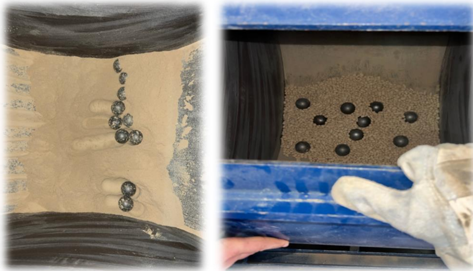
Figure III.6 : Machine Los Angeles utilisée pour le broyage des matériaux.
