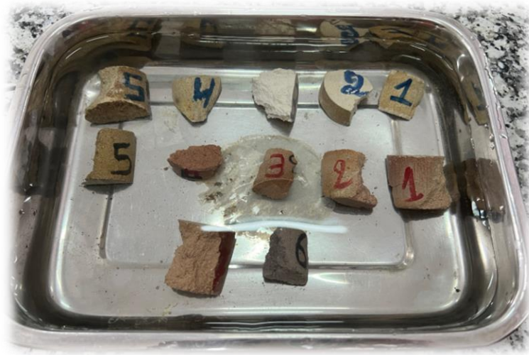
Figure IV.5 : Éprouvettes immergées dans l'eau pendant 24 h pour l'essai d'absorption d'eau
