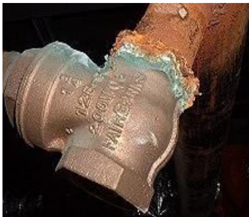
Figure 1.6. : Conditions requises à la corrosion galvanique
