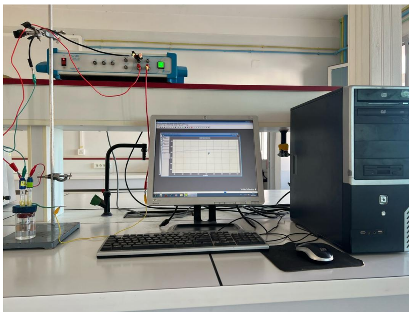
Figure III.1 : Dispositif des mesures électrochimiques.
