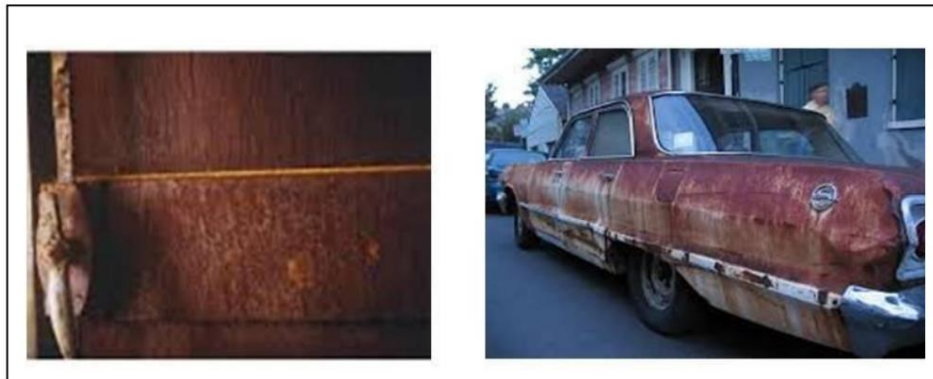
Figure I.3. : Corrosion générale (rouille) d'une pièce en acier
