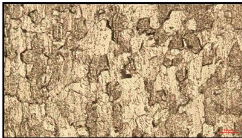
Figure 4.22. Zone affectée thermiquement 304L.
