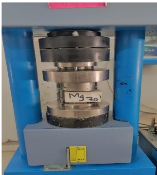
Figure II-10. Dispositif de l'essai de compression (a) schéma ; (b) photo.
