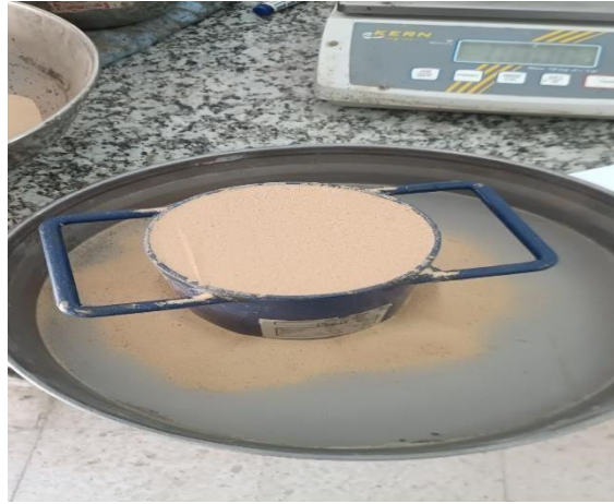
Figure II-4. Dispositif de mesure de la masse volumique apparente du sable.
