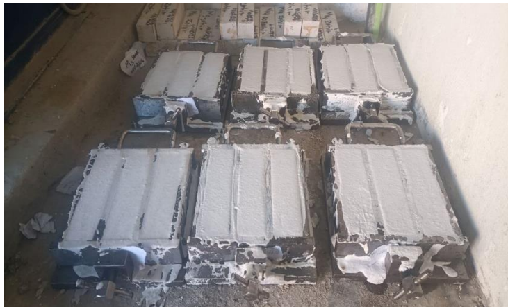
Figure II-8. Confection et mise en moule des éprouvettes.
