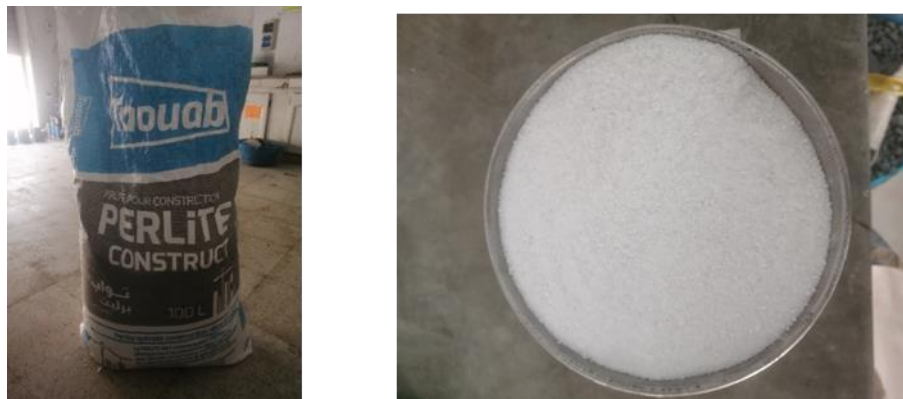
Figure II-5. Perlite expansée utilisée dans l'étude.
