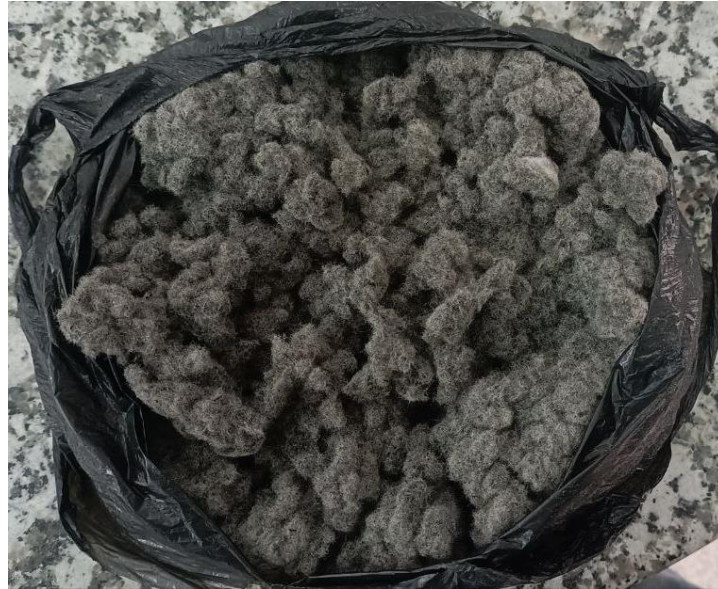
Figure II-6. Fibres de caoutchouc recyclé utilisées dans l'étude.
