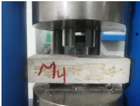
Figure II-9. Dispositif de l'essai de flexion 3 points (a) schéma ; (b) photo.
