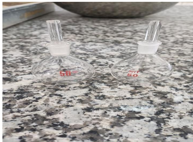
Figure II-2. Essai de masse volumique absolue du plâtre par pycnométrie à l'essence.
