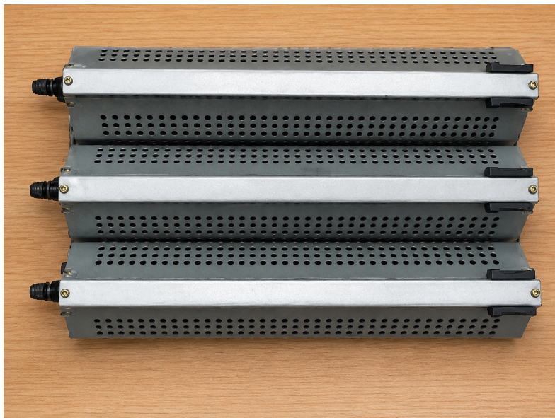
FIGURE III.6 – Platine de charge résistive de puissance
