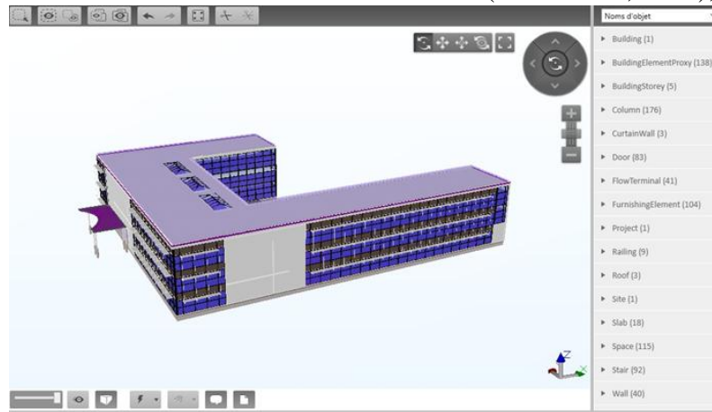
Figure I.3 : Vue d'un modèle BIM 3D, avec les informations sémantiques
