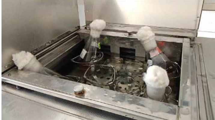
Figure.14. bain-marie avec une agitation permanente.
