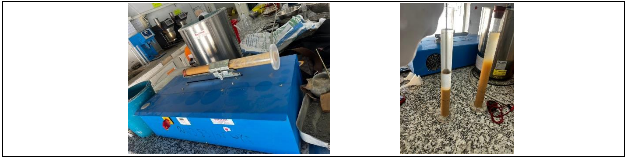
Figure B.6: essai équivalent du sable
