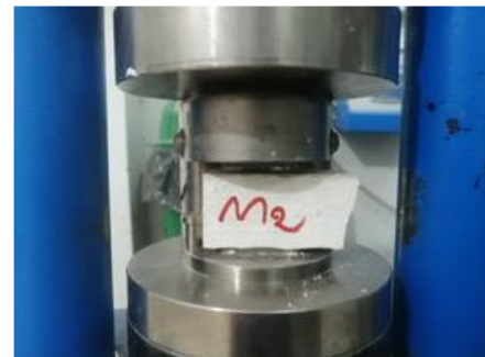
Figure III.8 : Dispositif d'essai de compression sur demi-prisme 40 \times 40 \text{ mm}^2
