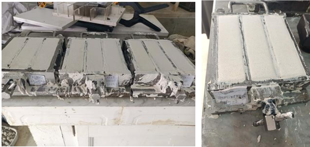
Figure III.14: Confection des éprouvettes 4 \times 4 \times 16 \text{ cm}
