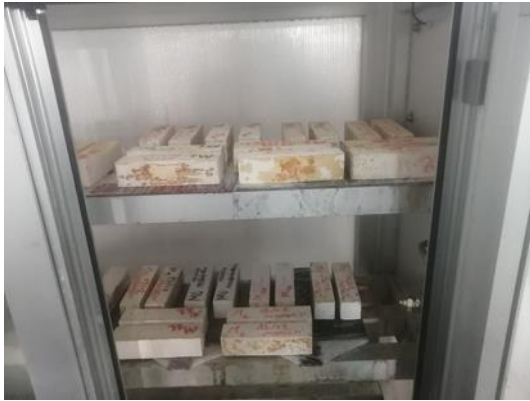
Figure III.12: Éprouvettes en chambre humide pendant la phase d'humidification
