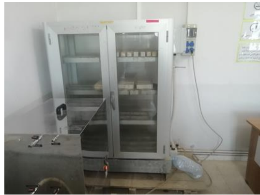
Figure III.11: Chambre humide à HR > 95 % utilisée
