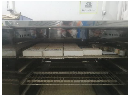
Figure III.13: Éprouvettes en étuve pendant la phase de séchage
