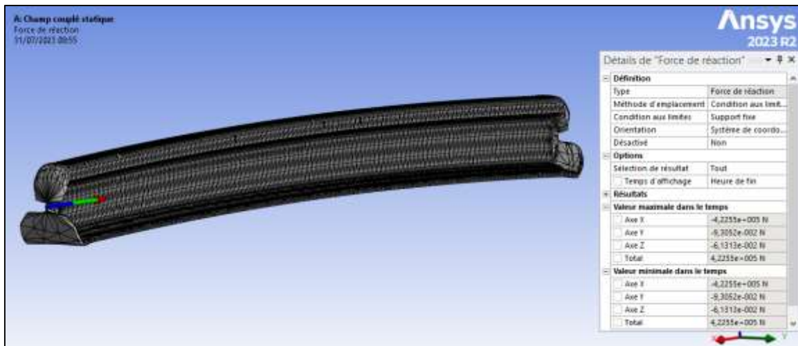
Figure III.23 : Force de réaction à l'encastrement obtenue par Ansys pour \Delta T = 20\text{ }^{\circ}\text{C}
