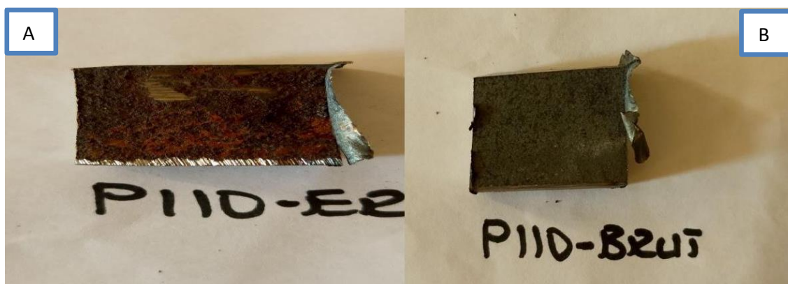
Figure 3.1: échantillons P110; (A) corrodé, (B) brute
