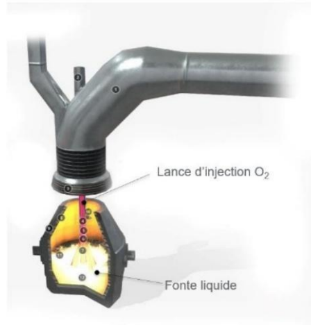
Figure.1.8: Procédé LD convertisseur à oxygène [16].
