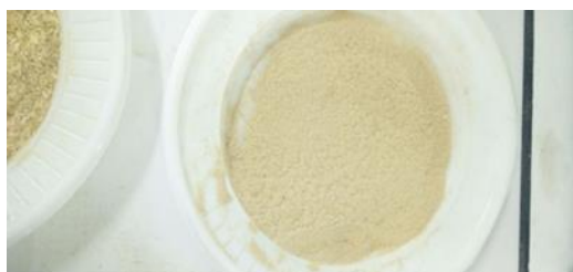
Figure 26: Broyage de la biomasse jusqu'à une granulométrie de 200 µm
