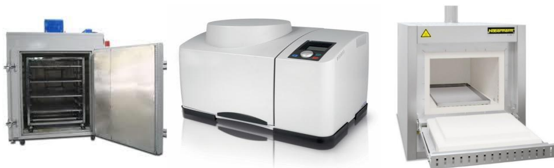
Figure 25: Étuve, Broyeur à boulets et Four d'incinération.
