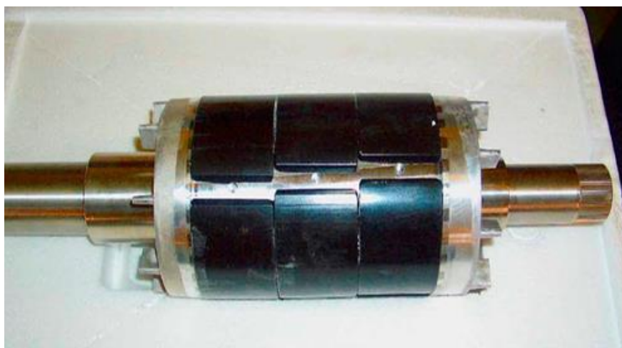
Figure 1-4 : Rotor Avec Des Aimants
