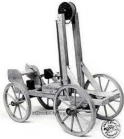
Figure I.6: | La « charrette de Rivaz », 1 re voiture avec un moteur à explosion.
