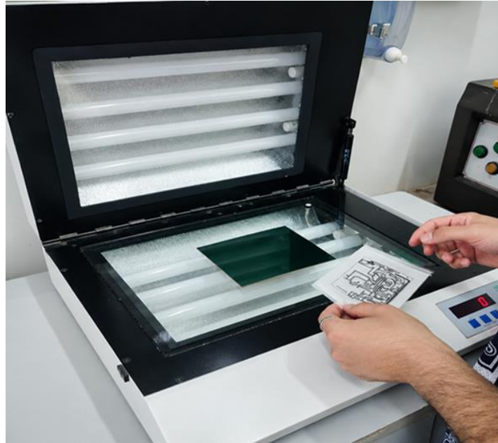
Figure III.5. Étape d'insolation de la plaque PCB sous lumière UV.
