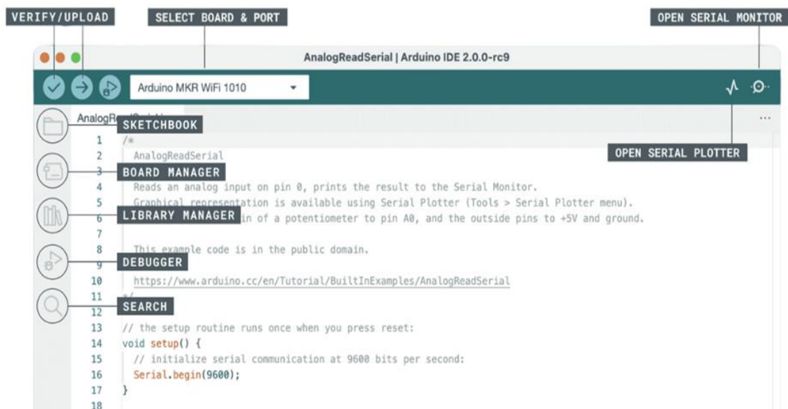
Figure II.20. Vue générale de l'environnement Arduino IDE [30].
