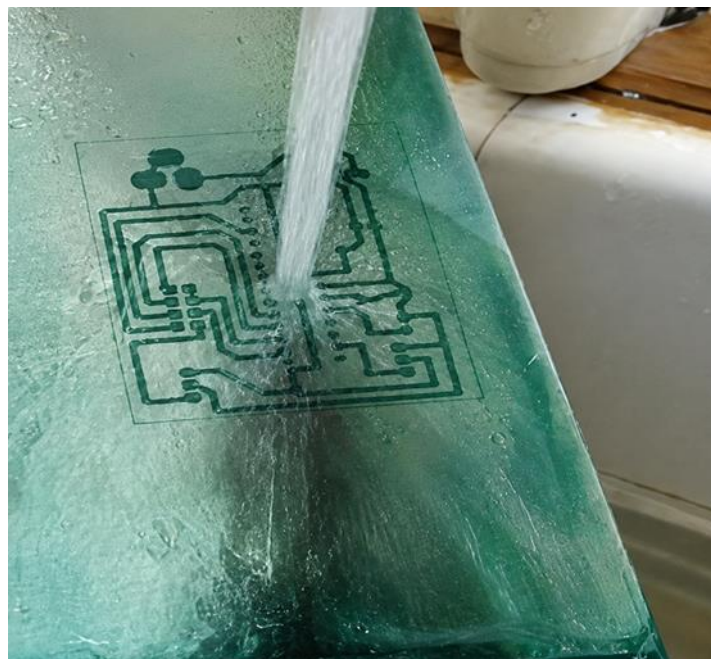
Figure III.8. Nettoyage et élimination du vernis après gravure.
