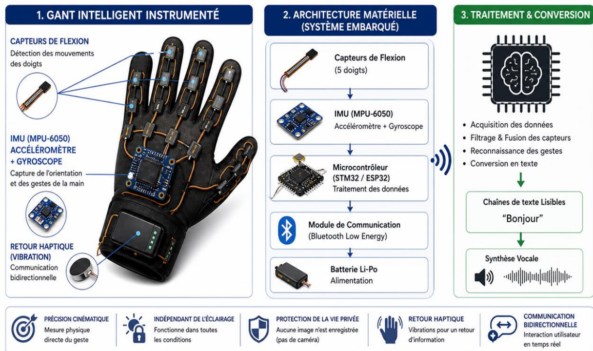
Figure I.4. Architecture matérielle d'un gant intelligent [12].
