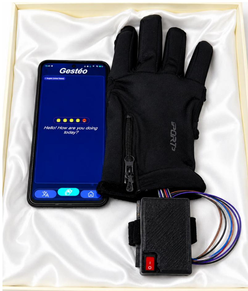
Figure III.12. Prototype final du gant intelligent IoT et son application mobile de traduction de la langue des signes en temps réel via une communication Bluetooth avec l'ESP32.
