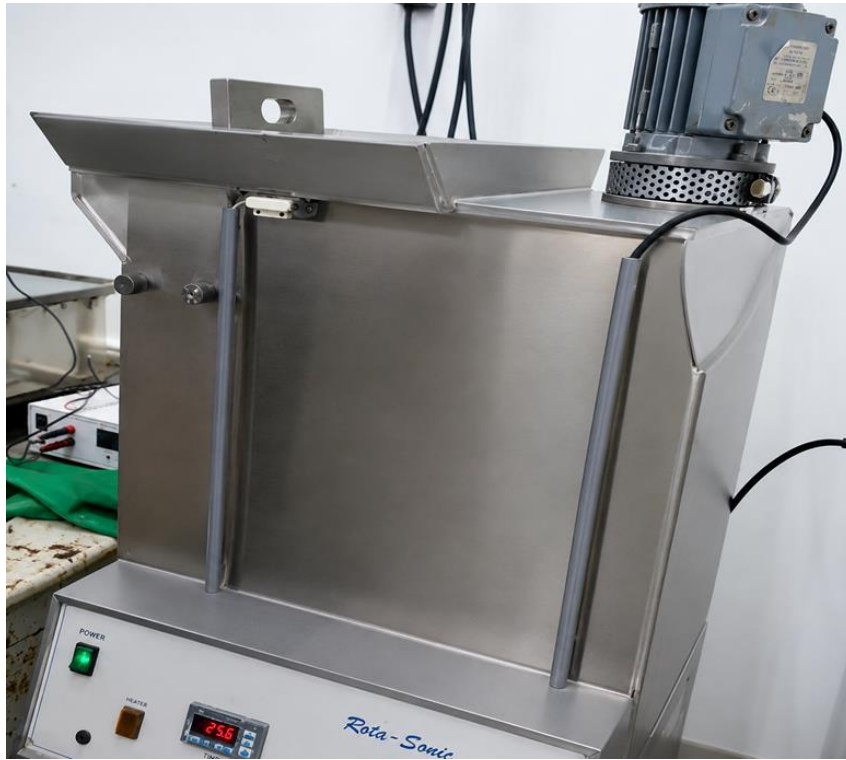
Figure III.7. Gravure chimique du PCB dans le bain de perchlorure de fer.
